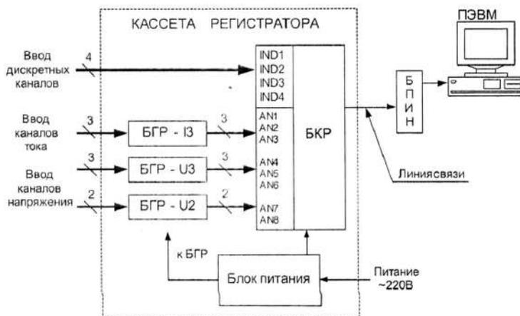
Рис. 1. Структурная схема регистратора
